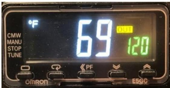
**¡NOTA!** El regulador de temperatura muestra la temperatura real del material y el punto de ajuste. El cuadro **AMARILLO** con la palabra "OUT" indica que los calentadores están energizados.
